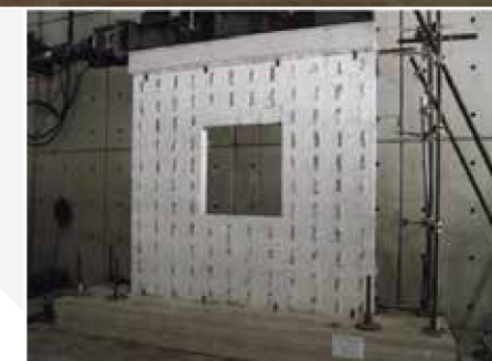
Links: Aardbevingstest op een ISOTEX-muur van twee etages Boven: Aardbevingstest op een dichte ISOTEX-muur Rechts: Aardbevingstest op een ISOTEX-muur met raam
