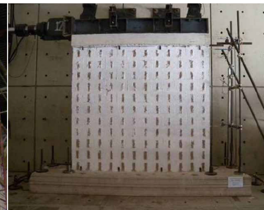
Links: Aardbevingstest op een ISOTEX-muur van twee etages Boven: Aardbevingstest op een dichte ISOTEX-muur Rechts: Aardbevingstest op een ISOTEX-muur met raam
